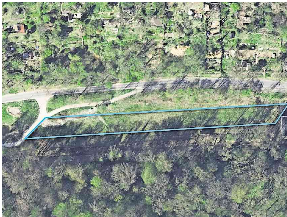
Im blau umrandeten Bereich soll der Regenüberlaufkanal in Mühlhausen zur Ertüchtigung des Kanals gebaut werden.
